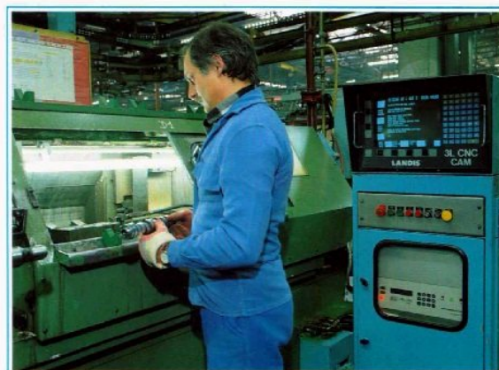
Philippe Poirier classe la ligne du vilebrequin sur un carter-cylindres (ph. 12), tandis que Dominique Chevallet contrôle un arbre à cames après usinage (ph.13).
